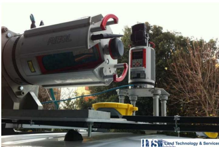
Figura 5 - Laser scanner su MMS.
