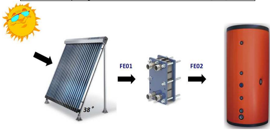
Figura 7. Schema produzione e fornitura energia a partire dai collettori solari
